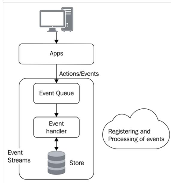
该图描绘了一个理想的事件处理系统，从应用程序开始到创建与某个事物相关的**事件**，然后将它们放入**事件队列**中进行进一步处理，这由**事件处理程序**来完成。基于**事件**的描述，由事件处理程序相应地处理它们，并将它们注册到**存储**中。
