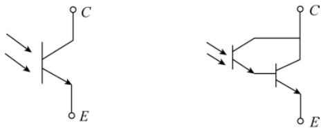
(a) 光敏晶体管的图形符号 (b) 光敏达林顿管的图形符号
