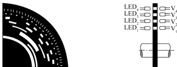
(a) 光电码盘的平面结构 (8 码道) (b) 光电码盘与光源、光敏元件的对应关系 (4 码道)
