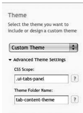
图15-23 jQuery UI下载构建器的高级主题设置展开，提供CSS范围和新主题文件夹字段
