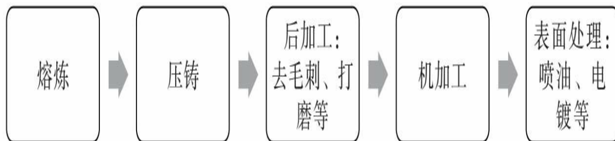
图1-1 安镁工艺流程图
