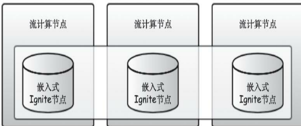
图5-5 Apache Ignite集群用于状态存储和管理的架构
