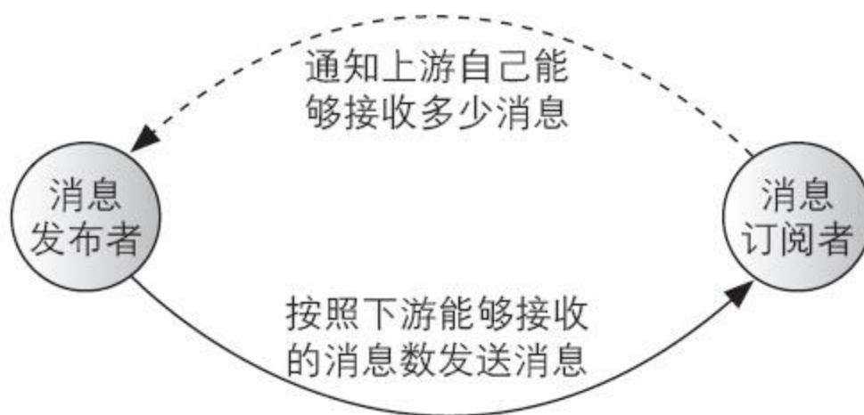
图2-15 Reactive Streams的工作原理
