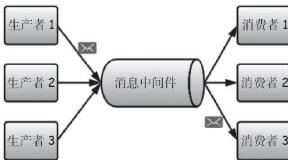
图8-1 消息中间件点对点模式的工作原理
