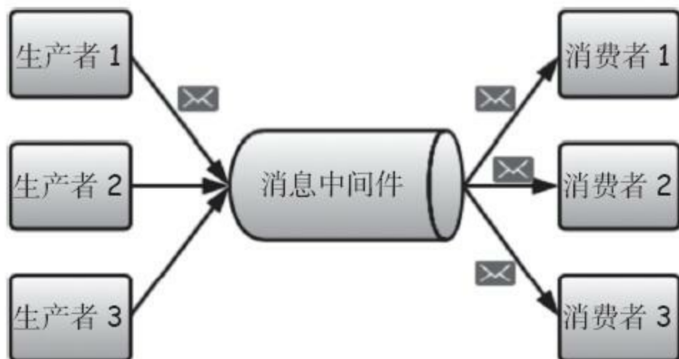
图8-2 消息中间件发布/订阅模式的工作原理
